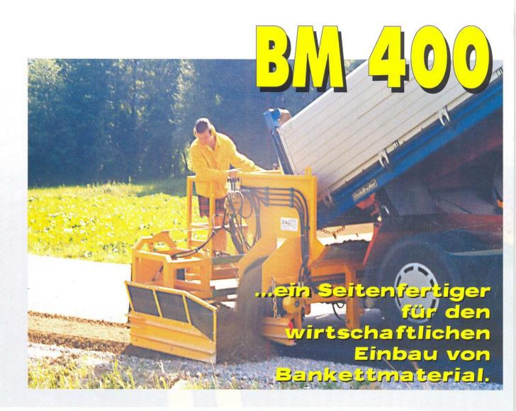
Prema propisu RVS 3.31 potrebno je, da se ugrađuje tačno definisana bankina. Za ugradnju takvih bankina, postoji mašina za bočno posipanje BM400, koja je izvedena kao jednoosovinska prikolica i koju može da vuče svako teretno vozilo.
