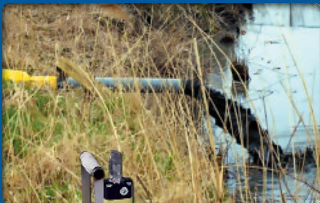
Standardna muljna pumpa, dubine 2,40m ima kapacitet otprilike 60 m<sup>3</sup> na sat i ima svoj motor. Montirana u prednjem delu podizne ruke na MOBITRAC-u.
